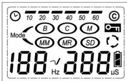
La pantalla LCD muestra el temporizador (10, 20, 30, 40, 50, 60 minutos y © (continua), los modos de funcionamiento (B, C, M, MM, MR, SD), el modo alternativo, la frecuencia de pulso, el ancho de pulso, la marca de batería baja, y el contador de la conformidad del paciente.
