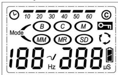
L'écran LCD affiche la Minuteur (10, 20, 30, 40, 50, 60 minutes et © Continue), Modes de Fonctionnement (B, C, M, MM, MR, SD), le Mode Alternatif, le Taux du Poulos, la Largeur du Poulos, la Pile Faible, et le Compteur de la Conformité du Patient.
